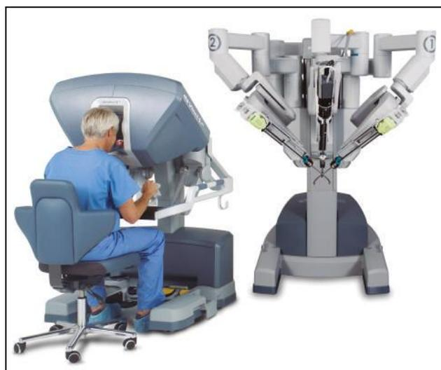
Fig. 1. Sistema de cirugía robótica...Cirujano consola y robot.
